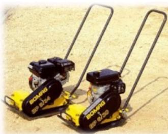
manjih količina zemljanih i sitnijih kamenih materijala u skućenim prostorima. Dijele se na **skakavce ili žabe** (engl. *vibratory tampers, njem. Schnellschlagstampfer, Explosionsstampfer, m.* – *slika lijevo*→) koji nabijanje izvode sporijim ili bržim udarima, te na **vibroploče** (engl. *vibrating plate, njem. Vibrationsplatten, f.* – *slika desno*←) koje zbijanje izvode vibracijom. Prvi se ne kreću, a pridržavaju se ručno prilikom skakutanja
