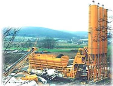
*concrete-mixing tower-plant*, njem. *Betonmischturmanlage, f.*) velikog instaliranog učinka →**detaljnije vidi**.
