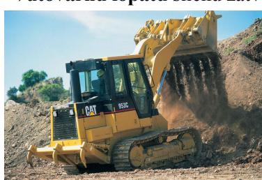
potrebi → **rijač (riper)** (*slika lijevo* ←). Rabi se za iskop i utovar te po potrebi prijenos (*slika desno* →), razastiranje i grubo planiranje sipkih zemljanih i kamenih gradiva. On je također →**univerzalni građevinski stroj** prikladan za izvedbu raznih vrsta zemljanih radova . →**detaljnije vidi <http://www.fiatkobelco.com> [http://www.zeppelin.de/D/lieferprogramm/02laden/6\\_cat\\_ketten.html](http://www.zeppelin.de/D/lieferprogramm/02laden/6_cat_ketten.html) ;**
