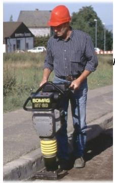
odnosno odskakivanja. Drugi se samostalno kreću uslijed inercije prouzročene vibracijom, uz istodobno ručno usmjeravanje. →**detaljnije vidi <http://www.bomag.de>: <http://www.dynapac.com> ; <http://www.rammax.de> ; <http://www.tunamakina.com/> ; <http://www.vibromax.de>**
