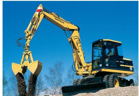
zahvatnom lopatom moguć je samo u uspravnom smislu odnosno lopata se spušta i odiže po okomici. Logistika otvaranja i zatvaranja zahvatne lopate kod →**bagera sajlaša** podržana je mehnizimima užadi a kod →**hidrauličnih bagera** također hidrauličnim
