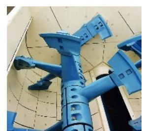
osovine s lopaticama. Djelomice miješaju beton osim prisilno slobodnim padom. Rabe se za također za miješanje krupozrnih betona ili vrućeg asfaltbetona.
