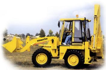
→dubinskom lopatom bagera. To je →univerzalni građevinski stroj kod kojega promjena alata na obje radne strane omogućava više različitih radnih operacija. Prikladan je za izvedbu raznih vrsta zemljanih radova manjeg obujma te manjih montažerskih radova ( montaža cjevovoda u rovovima i sl.) u okviru manjih gradilišta. Postoji mnogo različitih tipova bager-utovarivača u smislu njihove veličine, snage te posebice načina
