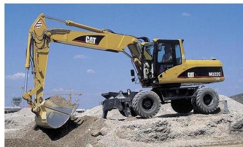
biti bez zubača i sa zubačima na donjem bridu lopate (slika desno dolje →) ovisno u tome da li se rabe pri iskop tla odnosno trošne stijene ili miniranih kamenih materijala. →*detaljnije vidi katalog pri <http://www.zepelin.de>*
