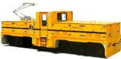
**akulokomotiva** (engl. *battery locomotive*, njem. *Akku-Lokomotive, f.*), vuča transportnih sredstava na tračnicama (primjerice vagona, vagon-mješalica za beton, postolja tehnološke opreme itd.) koja se najčešće primjenjuje u tunelogradnji te ponegdje u proizvodnji gradiva odnosno građevinskih elemenata i sklopova. Akulokomotivu pokreće električna struja iz akumulatora koje nosi na sebi. Masa akumulatora omogućava također povećanje vučne sile akulokomotive. Uglavnom nosi jedan do
