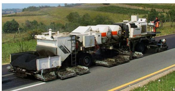
koji “u hodu” istovremeno stružu asfaltni sloj, mijesaju ostrugani usitnjeni materijal sa vezivom i ponovo ugrađuju izmješani materijal pomoću više uređaja smještenih ispod pokretnog postolja na gusjenicama. **Obnova asfaltnih zastora moguća je, kao treće, tzv. vrućim postupkom** pomoću **vrlo složenih “remiksera”** (engl. *hot mixer, hot recycler, hot recycling train*, njem. *Heissrecycler, Heissremixer, Heissrecycling Mixer, m.* – slika dolje lijevo←) koji (također “u hodu”)
