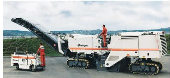
**glodalica, “freza”** (engl. *milling machine*, njem. *Fräsegerät, n.*), samohodni građevinski stroj za struganje posebice asfaltbetonskih zastora cestovnih prometnica, pista i sličnih plošnih građevinskih konstrukcija. Glodalica je najčešće na podvozju sa →**gusjenicama** (*slika desno →*) rjeđe s gumenim kotačima (*slika lijevo ←*). Na podvozju je ovješeno prema dolje otvoreno korito.
