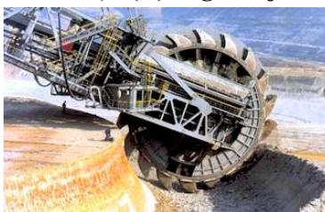
(engl. *bucket wheel excavator*, njem. *Schaufelradbagger, m.* – slika lijevo ←) koji se, kao veliki bageri velikog učinka, uglavnom rabe u otvorenim rudokopima.
