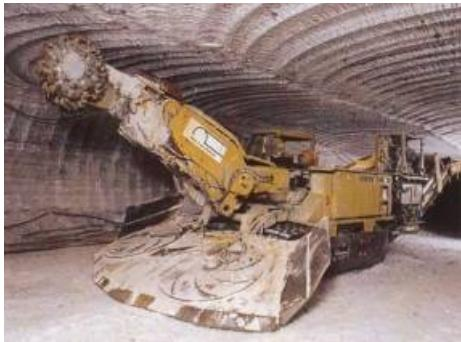
obuhvaća (1) →**bagere** s udarnim čekićem na kraku te ostale slične (2) strojeve uglavnom na gusjenicama s **otkopnom rotirajućom glavom** na vrhu kraka (engl. *miner, roadheader*, njem.
