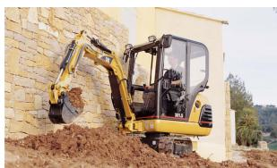
velikih →**hidrauličnih bagera** gusjeničara. Služe za iskop manjih količina zemljanih materijala. Nazivaju se još **mehaničke lopate**. →uz ostale web-adrese velikih proizvođača građevinskih strojeva za zemljane radve (Caterpillar, Fiatcobelko, Komatsu, Icb, itd) vidi još [http://www.gehl.de/pages/d\\_index.html](http://www.gehl.de/pages/d_index.html) ; <http://www.ihicompactexcavator.com/> ;<http://www.kubota.de> ; <http://www.neuson.com> ;
