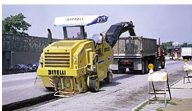
Unutar korita nalazi se rotirajući valjak koji nosi posebno oblikovane šiljke što stružu (glođu) zastor. Korito je tako izvedeno da iza sebe ostavlja izduženu gomilu ostruganog materijala ili se materijal preko transportne trake puni u vozila ispred glodalice. Samo struganje asfalta može biti hladno ili vruće a što znači da glodalica izvodi prethodno zagrijavanje asfaltnog zastora. →**detaljnije vidi** <http://www.bitelli.com/>; <http://www.dynapac.com>; <http://www.wirtgen-group.com>
