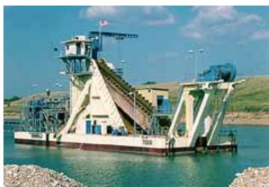
Postoji različite vrste i oblici plovnih bagera u smislu njihove veličine, snage i učinka, načina plovlenja te posebice konstrukcijske logistike rada opreme za iskop pod vodom i odvajanje vode nakon iskopa.
