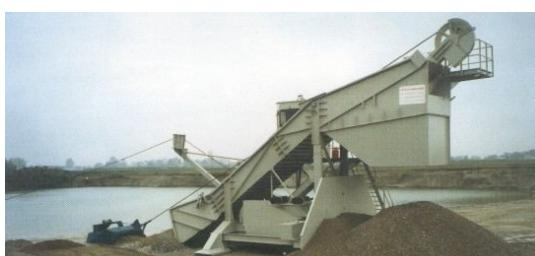
**sajlaša** za iskop kamenih aluvijalnih materijala iz vode s kopna pomoću jedne povlačne košare (→**skrejper**) koja se zabacuje i vuče pomoću posebne opreme u obliku žičare. Kabel-bager obuhvaća, uz ostalo, opremu s druge strane vode (tornjevi, koloture itd.) koja drži i vodi užad sa opremom za iskop što preko kolotura putuje po njoj. Može biti opremljen sa zatvorenom ili otvorenom povlačnom košarom. →**detaljnije vidi** <http://www.stichweh.de>
