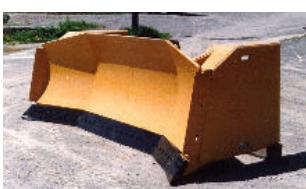
njegovu podvozju s prednje strane. Može biti različito oblikovan, tj. može biti zaobljen i sa strane zatvoren (tzv. **U-nož** za iskop tvrdog tla i kamenih materijal - *slika lijevo*←), može biti ravan (tzv. **S-nož** služi uglavnom za razatiranje i planiranje sipkih gradiva - *slika desno gore* →↑), može se djelomično zakretati i podizati
