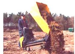
**“miniutovarivači”**(engl. *skid-steer loader*, njem. *Minilader*, m.), mali, robusni, vrlo
